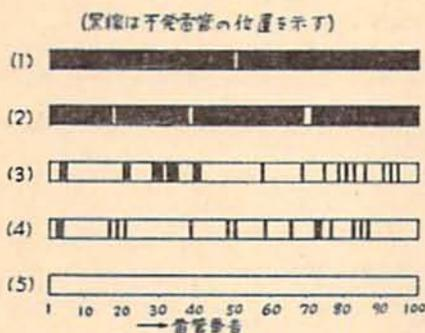
図6 試験点火器を用いた時の充電電圧の変化に依る不発分布の状況
