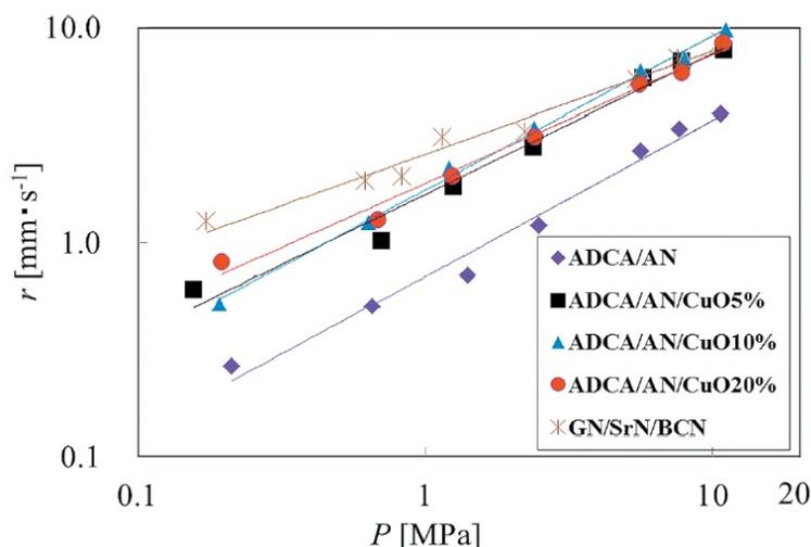
図2 ADCA/AN系ガス発生剤の線燃焼速度
