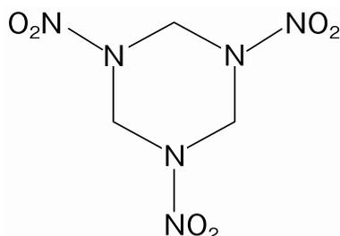
図 1 RDX の化学構造
